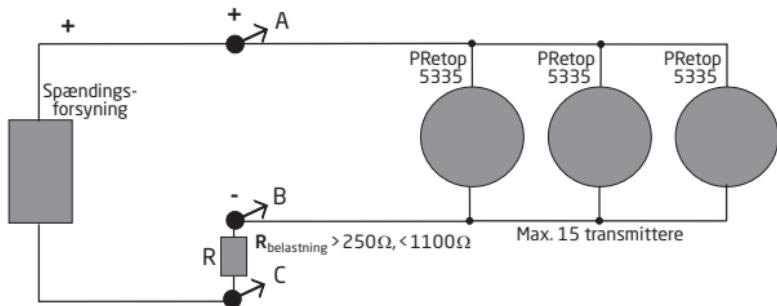
Udgangene på op til 15 transmittere kan paralleltforbindes for digital HART®-kommunikation på 2-ledere.
